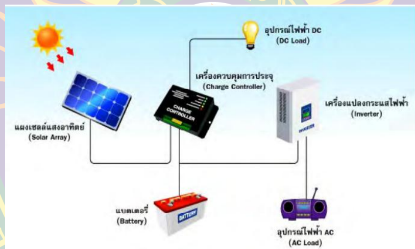
ภาพที่ 7 อุปกรณ์ของระบบการผลิตกระแสไฟฟ้าจากเซลล์แสงอาทิตย์ ที่มา; รัฐพล (2549)
