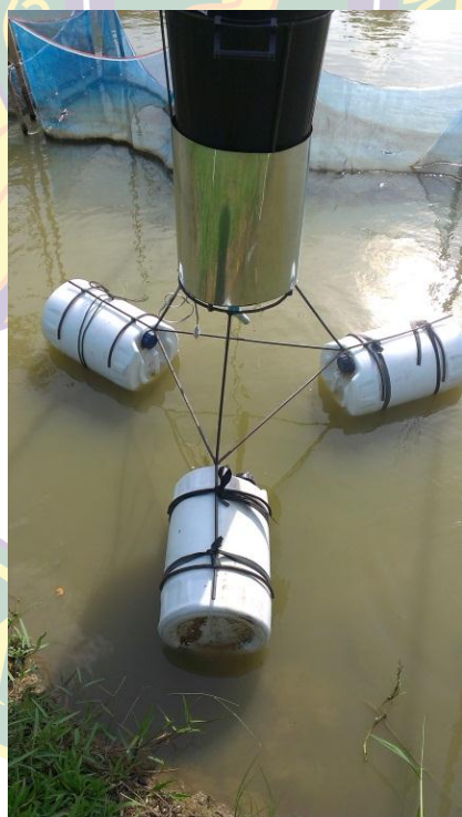
ภาพภาคผนวกที่ 4 การทดสอบประสิทธิภาพโครงสร้างและท่อนลอยน้ำ
