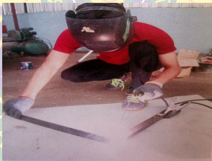
ก - 2 การเชื่อมโครงตู้อบพลังงานแสงอาทิตย์
