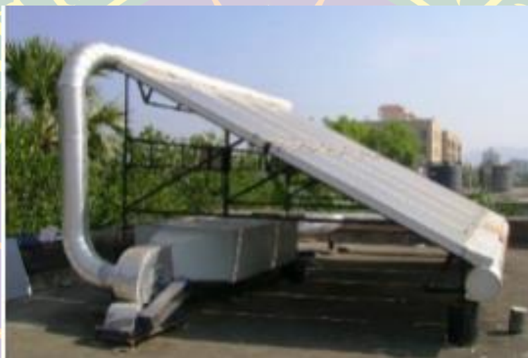
ภาพที่ 2.7 เครื่องอบแห้งแบบใช้แผงรับความร้อนโดยใช้พัดลมดูดอากาศร้อน เพื่อลดความชื้นของผลิตภัณฑ์
