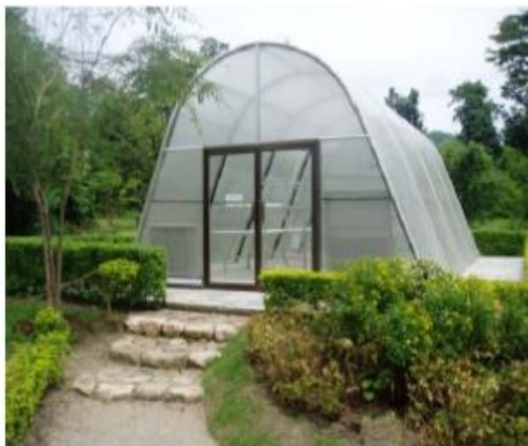
ภาพที่ 2.4 เครื่องอบแห้งแบบรับแสงอาทิตย์โดยตรง ชนิดอุโมงค์หลังคาโค้ง
