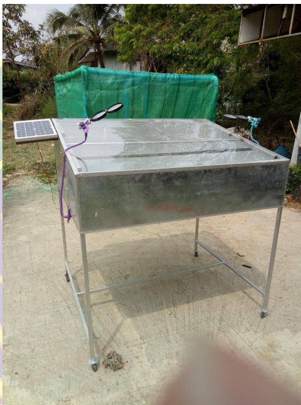
ก - 7 ตู้อบพลังงานแสงอาทิตย์ประสิทธิภาพสูง
