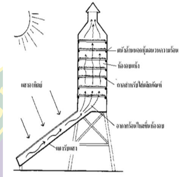
ภาพที่ 2.5 เครื่องอบแห้งแบบใช้แผงรับแสงอาทิตย์ (Indirect)
