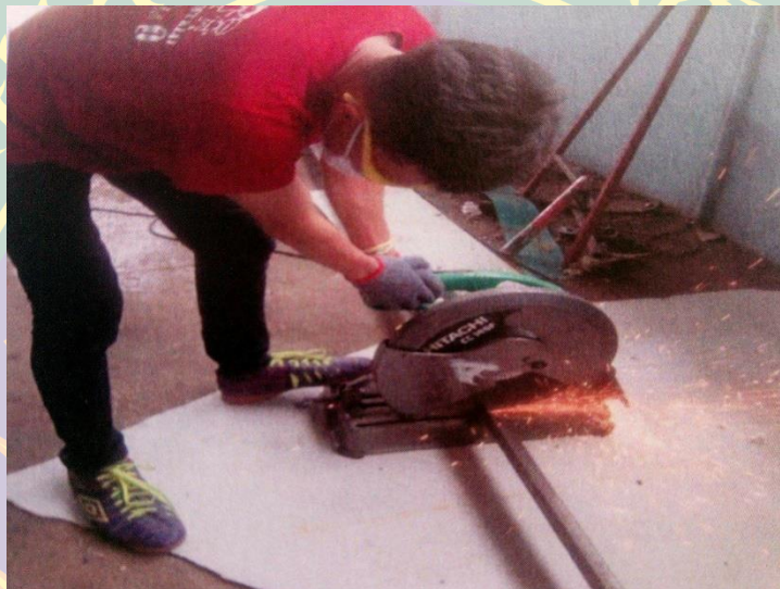
ก - 1 ตัดเหล็กทำโครงสร้าง
